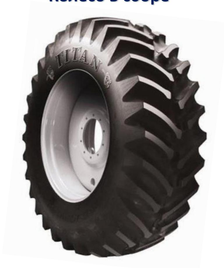
А это **КОЛЕСО В СБОРЕ**: шина смонтированная на колесо и накачанная до рабочего давления накачки.
