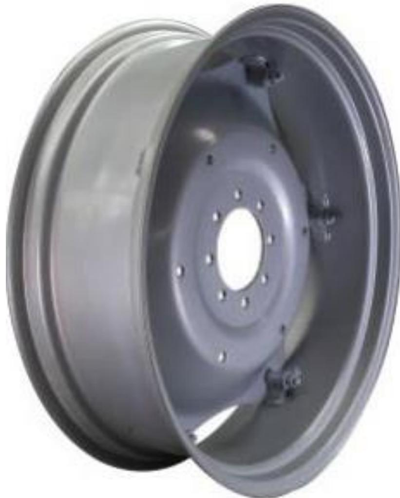
**КОЛЕСО** состоит из обода, на который монтируется шина и **ДИСКА**, который служит для передачи вертикальной нагрузки и крутящего момента от ступицы к ободу.
