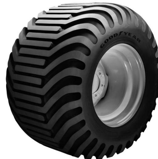
Первая группа шин «второго эшелона» для с/х орудий это флотационные шины. Более подробно мы поговорим о них в специализированном материале о шинах такого типа. Сейчас же скажу, что свойства этих шин – плавучесть, это следствие способности нести высокую нагрузку при достаточно низком давлении. Достигается оно широким пятном контакта, которое создаётся в основном геометрией шин, а не какой-то специальной конструкцией.
