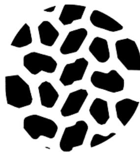
При завышенном давлении накачки пятно контакта округляется и уменьшается в размерах (для радиальных шин оно сначала укорачивается).
