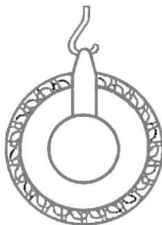
**ЗАПРЕЩАЕТСЯ ЗАЧАЛИВАТЬ ШИНЫ КАНАТНЫМИ И ЦЕПНЫМИ СТРОПАМИ ИЛИ КРЮКАМИ**
